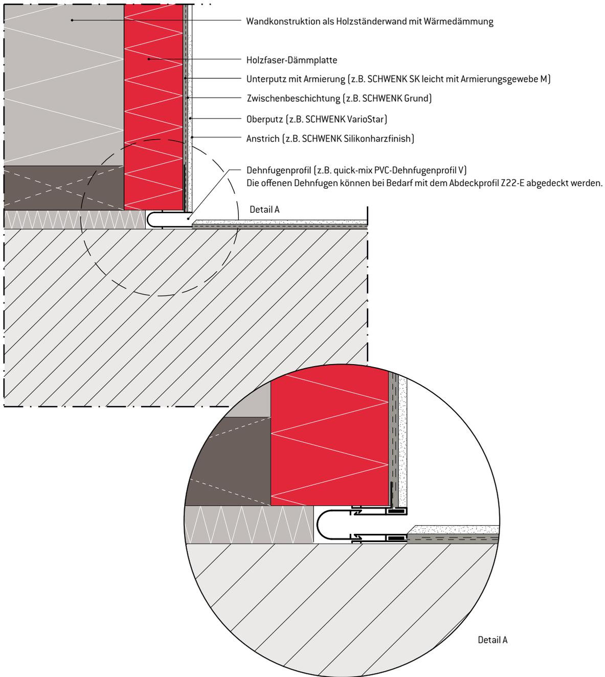
Darstellung eines SCHWENK Wärmedämm-Verbundsystems.
