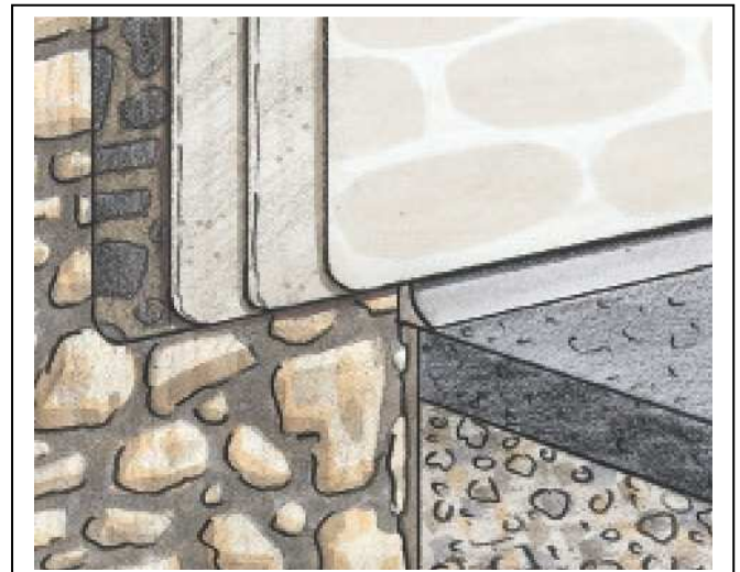
Abb. 21: Hohlkehle aus Zementmörtel
