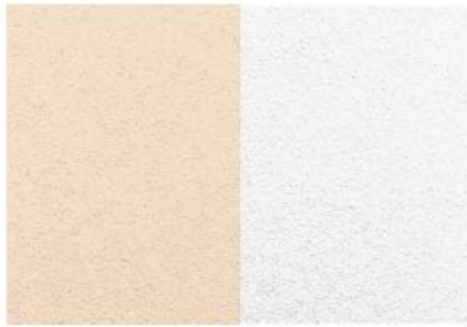
Scheibenputz- und kratzputzähnliche Struktur
